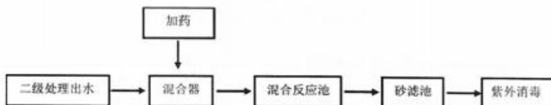
图 3-5 污水深度处理工艺流程图
