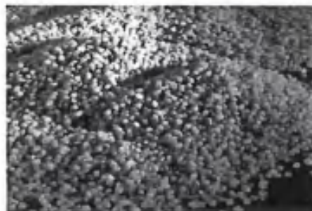
图 2-3 反硝化深床滤池滤料
