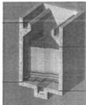
图 2-3 反硝化深床滤池结构图
