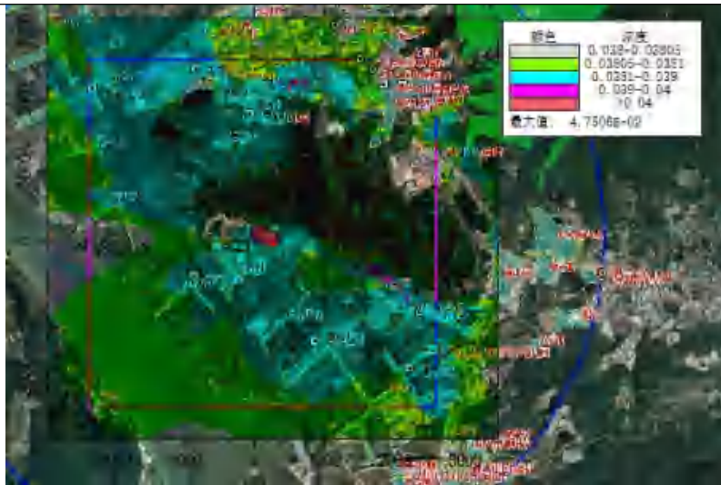
本项目 PM 2.5 95%保证率日均浓度叠加已批在建源预测图 (单位: mg/m 3 )
