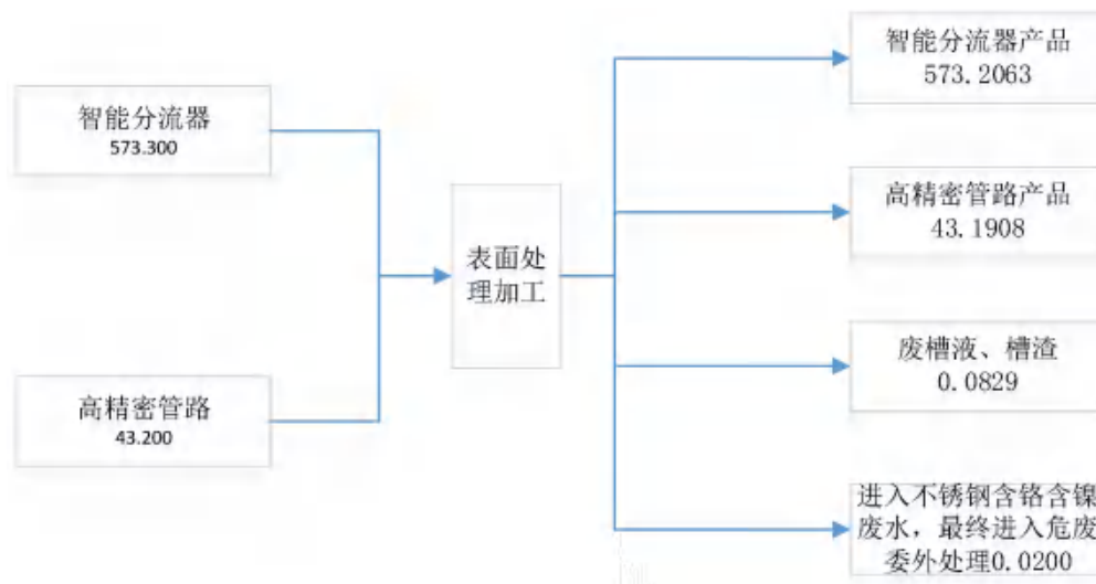
图 3.3-3 项目铬平衡图 单位： \text{m}^3/\text{a}
