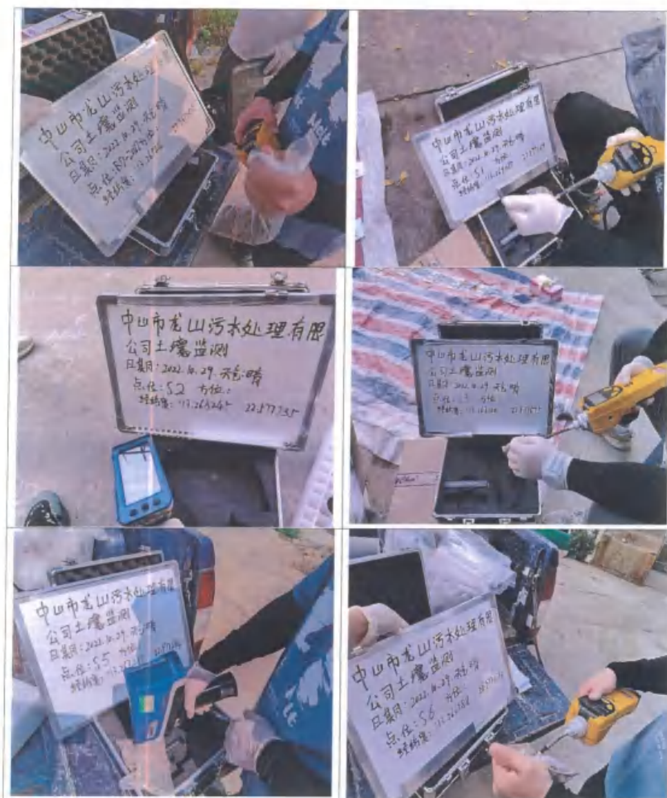
图 2.5-1 土壤现场快筛照片
