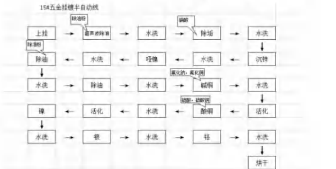
图 4.2-12 14#五金挂镀半自动线工艺流程及产污节点
