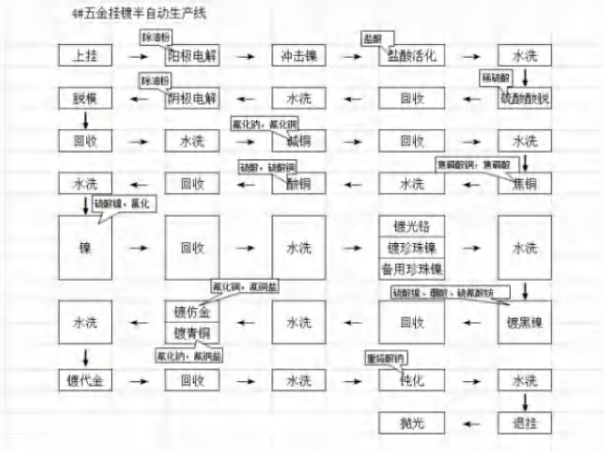
图 4.2-4 4#五金挂镀半自动线工艺流程及产污节点
