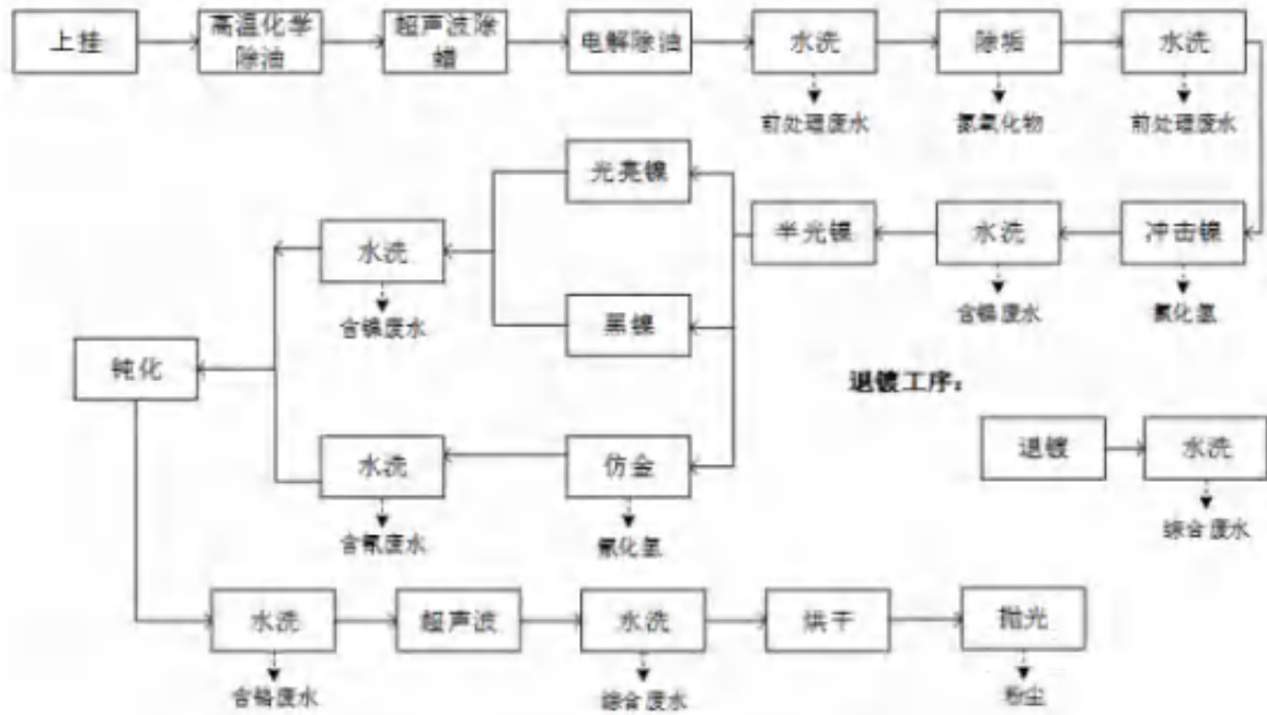
图 4.2-16 2#五金挂镀自动线工艺流程及产污节点
