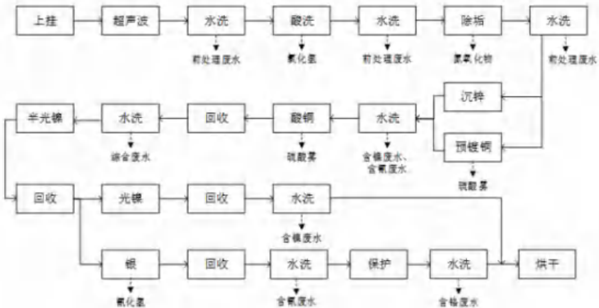
图 4.2-5 5#五金挂镀半自动线工艺流程及产污节点
