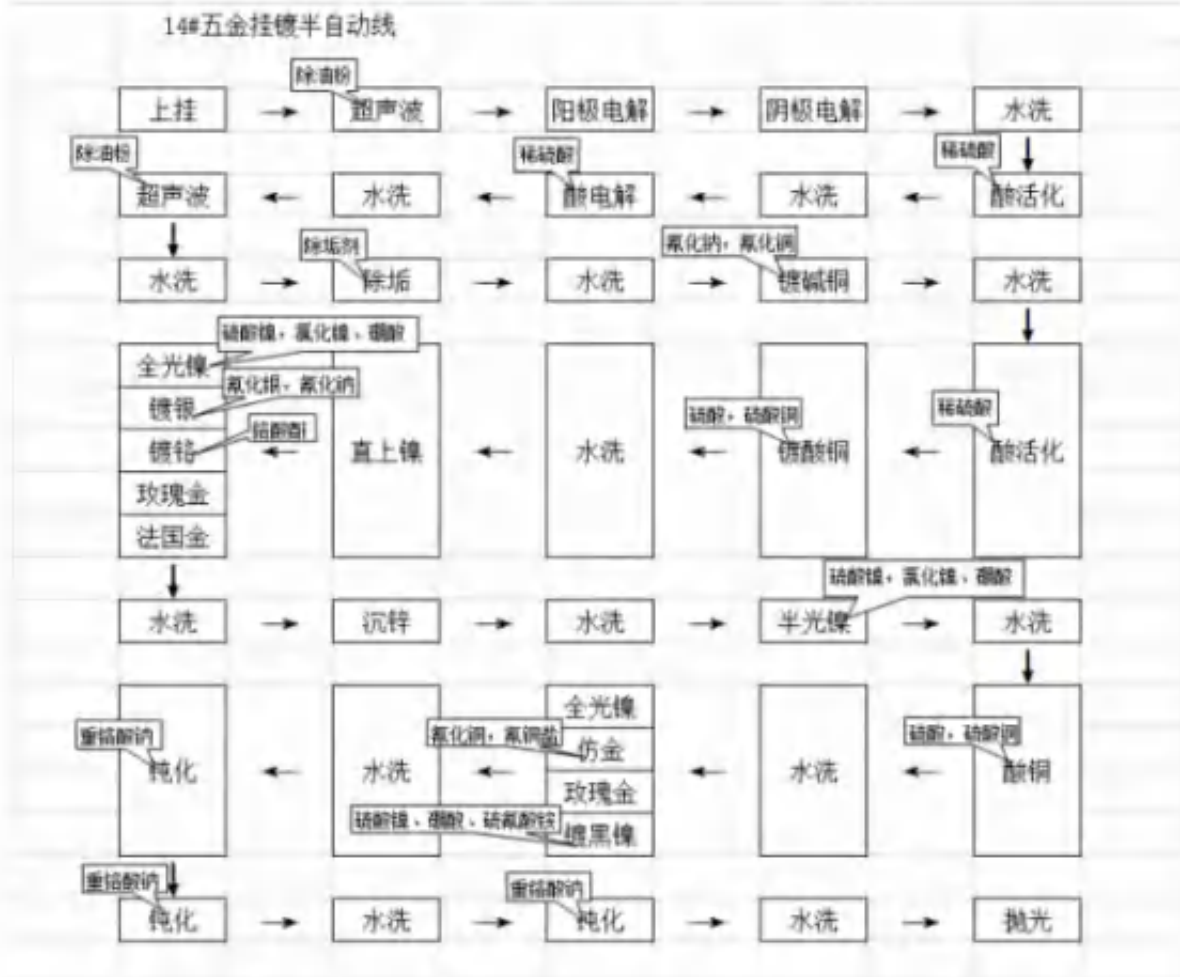
图 4.2-12 14#五金挂镀半自动线工艺流程及产污节点
