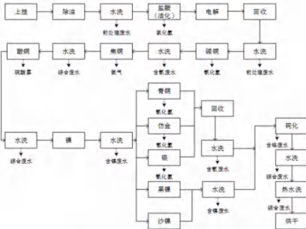
图 4.2-1 1#五金半自动挂镀线工艺流程及产污节点
