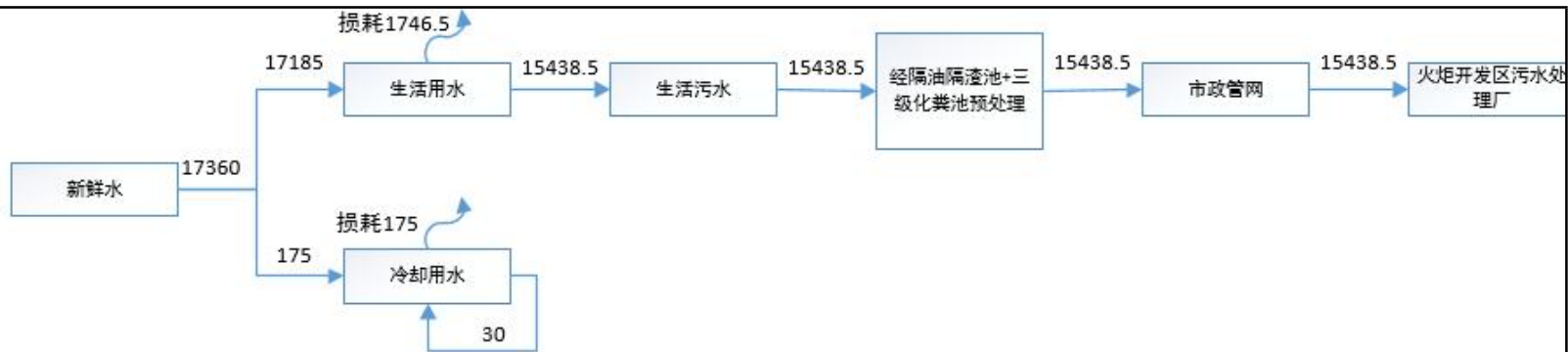
图 2 改扩建后全厂水平衡图（单位：t/a）
